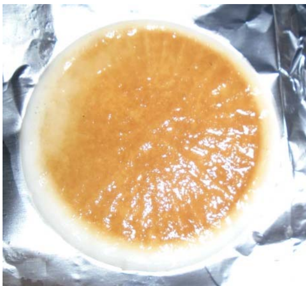
Figura 4.1-5: Coleta de amostras de clorofila-A com filtro de membrana.
