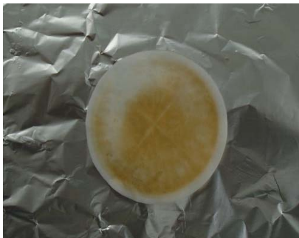
Figura 4.1-20: Coleta de clorofila – A com filtro de membrana
