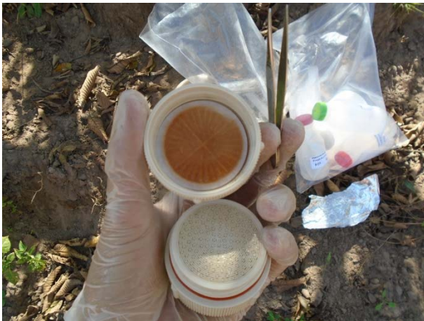
Figura 4.3-47: Ponto A07: Membrana após 60ml de água
