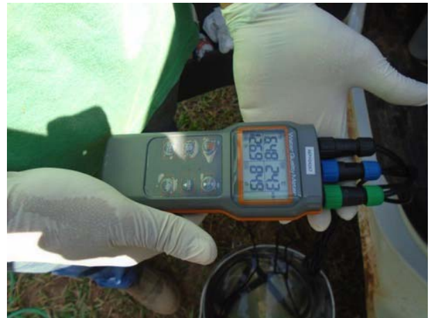
Figura 4.1-16: Uso do multiparâmetro para análise da água no ponto de coleta.
